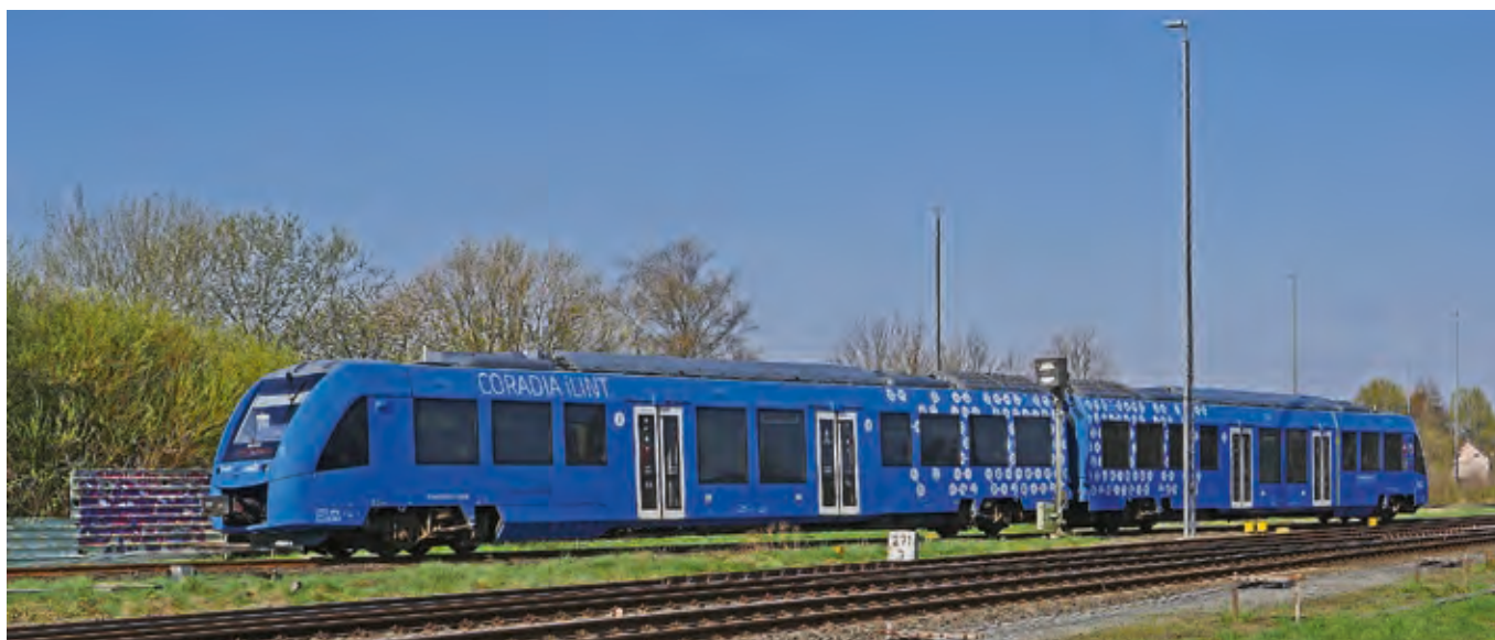
Первый в мире пассажирский поезд на водородном топливе Coradia iLint, разработанный французской компанией Alstom, начал перевозить пассажиров в Нижней Саксонии в 2018 году
